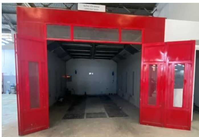
Hình 5. Cấu tạo buồng sơn tại Cơ sở
